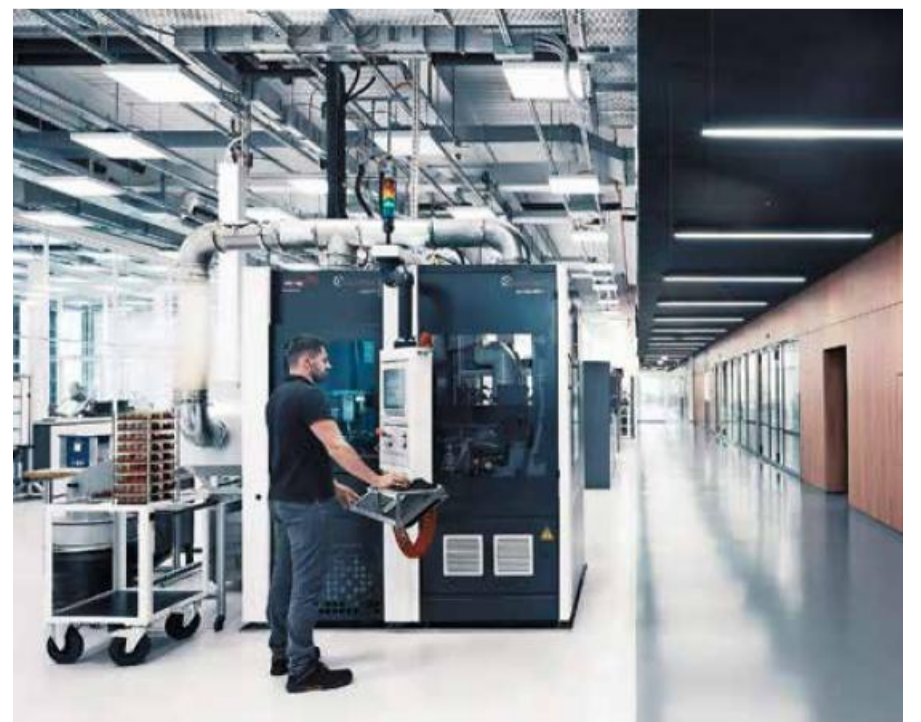
Werk- und Gehäuseteile werden mit hochpräzisen Dreh- und Fräszentren gefertigt.
